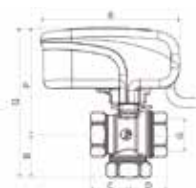
Válvula de zona motorizada con tapón obturador
